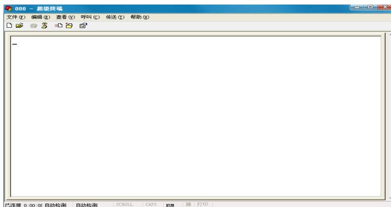
将中控电源断开，按住计算机键盘“ESC”键，给中控通电进入下列界面：
