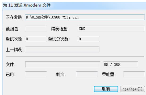
文件传送完毕此对话框自动关闭，将中控重新上电启动，底核写入完毕。重新用 IC900rev2 设置程序进行设置。
