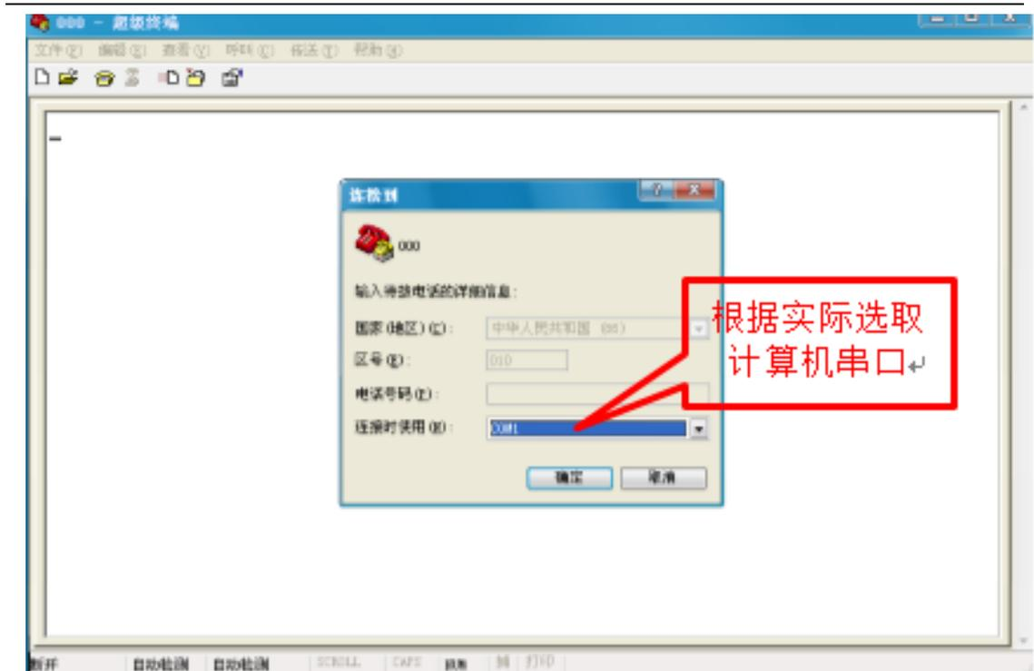
选取设置使用计算机的串口，点击“确定”进入下面对话框：
