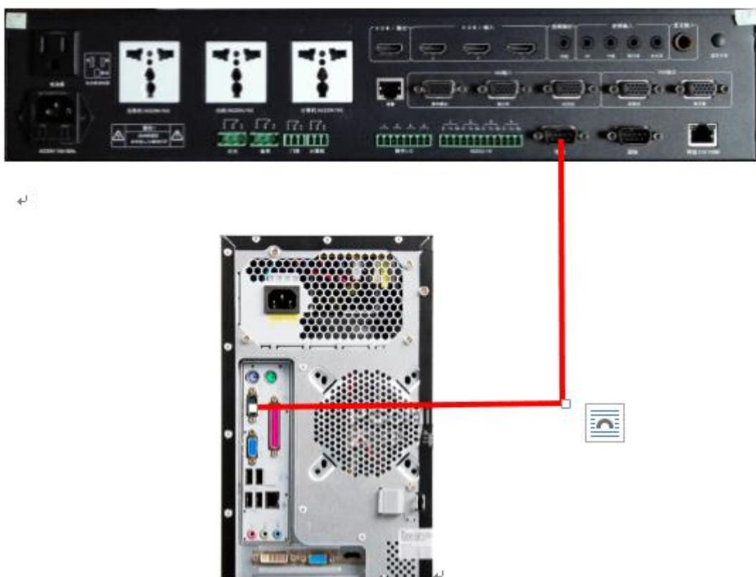
2. 使用计算机系统（XP 自带、WIN7 以上及服务器版本需要下载）中的“超级终端”通讯工具软件进行设置。
